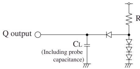
$C_L = 15\text{pF}$ : DUTY,  $I_{DD}$ ,  $t_r$ ,  $t_f$
