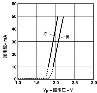
図3. 順電圧 - 順電流特性
