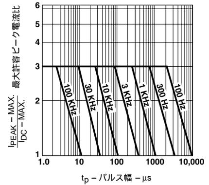
図2. パルス幅 - 最大許容ピーク電流特性
