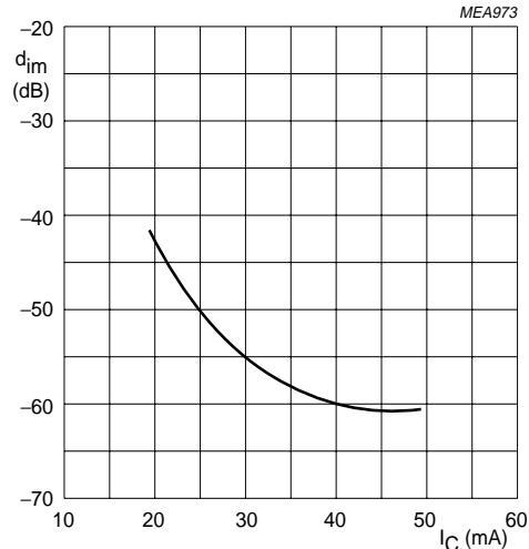
$V_o = 500 \text{ mV}$ ;  $f_{(p+q-r)} = 793.25 \text{ MHz}$ ;  $V_{CE} = 8 \text{ V}$ ;  $T_{amb} = 25^\circ\text{C}$ ;
