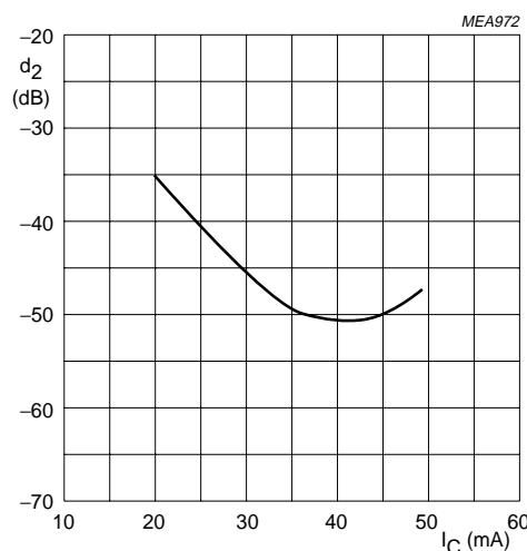
$V_o = 275 \text{ mV}$ ;  $f_{(p+q)} = 810 \text{ MHz}$ ;  $V_{CE} = 8 \text{ V}$ ;  $T_{amb} = 25^\circ\text{C}$ ;  $R_L = 75 \Omega$ .
