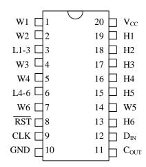
DS1806 20-Pin DIP (300-mil) DS1806S 20-Pin SOIC (300-mil) DS1806E 20-Pin TSSOP (173-mil) See Mech. Drawings Section
