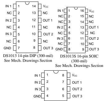
DS1013M 8-pin DIP (300-mil) See Mech. Drawings Section
