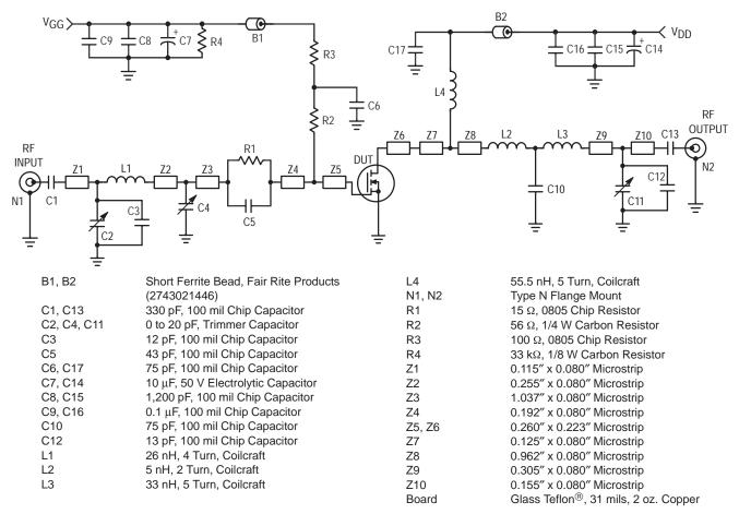
Figure 19. 135 – 175 MHz Broadband Test Circuit
