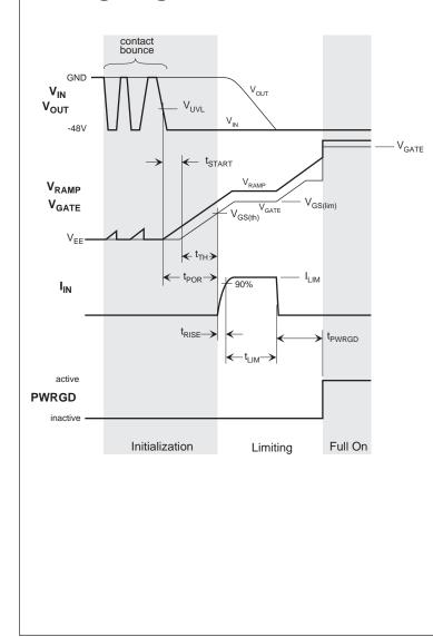
$$\begin{split} I_{LIM} &= \frac{V_{SENSE}}{R_{SENSE}} \\ t_{START} &= 1.2V \frac{C_{RAMP}}{I_{RAMP}} \\ t_{TH} &= V_{GS(th)} \frac{C_{RAMP}}{I_{RAMP}} \\ t_{POR} &= t_{START} + t_{TH} \\ t_{RISE} &\approx \frac{C_{RAMP}}{g_{fs} \left(\frac{I_{RAMP}}{0.9I_{LIM}} - \frac{R_{SENSE}}{R_{FB}}\right)} \\ t_{LIM} &\approx V_{IN} \frac{C_{LOAD}}{I_{LIM}} - \frac{1}{2} t_{RISE} \\ t_{PWRGD} &= \left(V_{INT} - V_{GS(lim)} - 1.2V\right) \frac{C_{RAMP}}{I_{RAMP}} \end{split}$$
