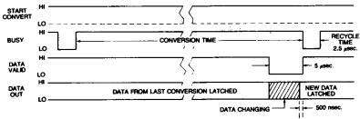
START CONVERT (PIN 21) IS TIED TO +5V dc (PIN 19).
