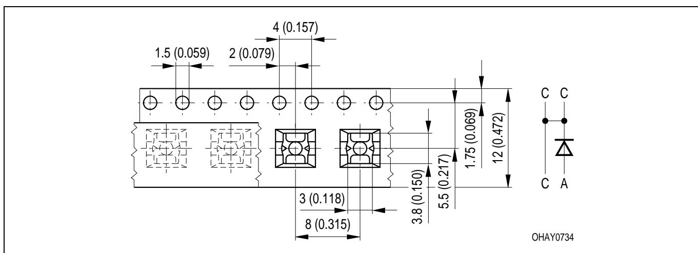
Maße werden wie folgt angegeben: mm (inch) / Dimensions are specified as follows: mm (inch).
