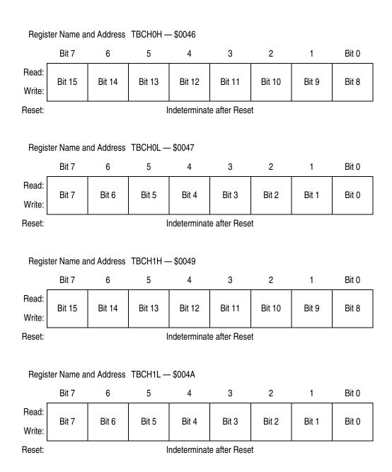
Figure 20-9. TIMB Channel Registers (TBCH0H/L-TBCH1H/L)
