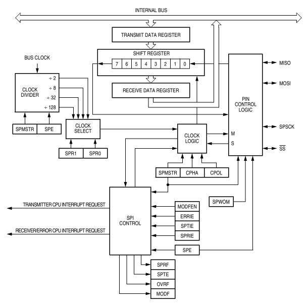
Figure 19-1. SPI Module Block Diagram
