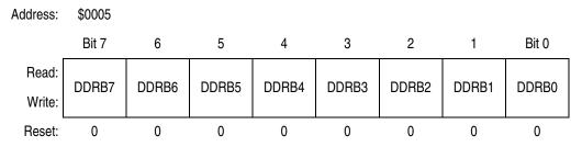
Figure 22-6. Data Direction Register B (DDRB)
