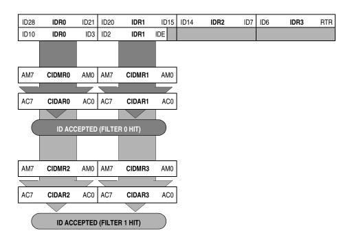
Figure 23-4. Dual 16-Bit Maskable Acceptance Filters
