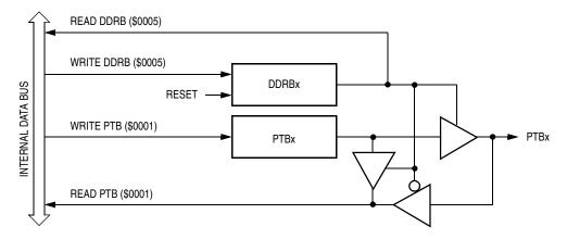
Figure 22-7. Port B I/O Circuit
