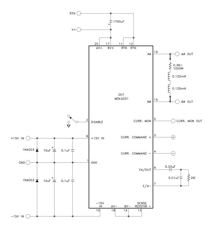
TYPICAL TEST SCHEMATIC
