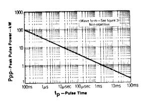
FIGURE 1 PEAK PULSE POWER VS. PULSE TIME
