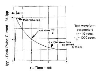
FIGURE 3 PULSE WAVEFORM
