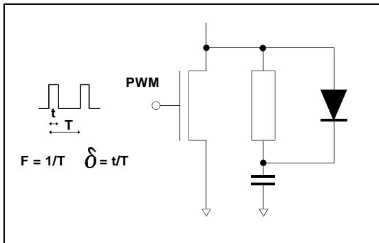
**Fig. C : DEMAGNETIZING DIODE.**
