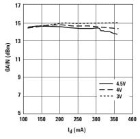
Figure 31. Gain vs  $I_{ds}$  and  $V_{ds}$  at 900 MHz.
