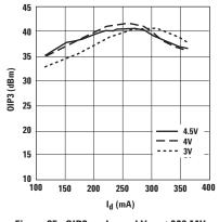
Figure 25. 0IP3 vs.  $I_{ds}$  and  $V_{ds}$  at 900 MHz.
