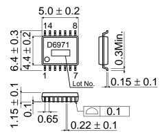
SSOP-B14 (UNIT: mm)
