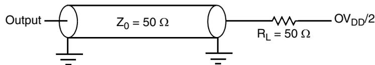
**Figure 23. I<sup>2</sup>C AC Test Load**
