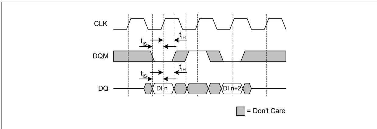
**Figure 27 Basic WRITE Timing Parameters for DQs**
