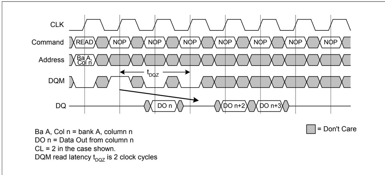
Figure 23 READ Burst - DQM Operation
