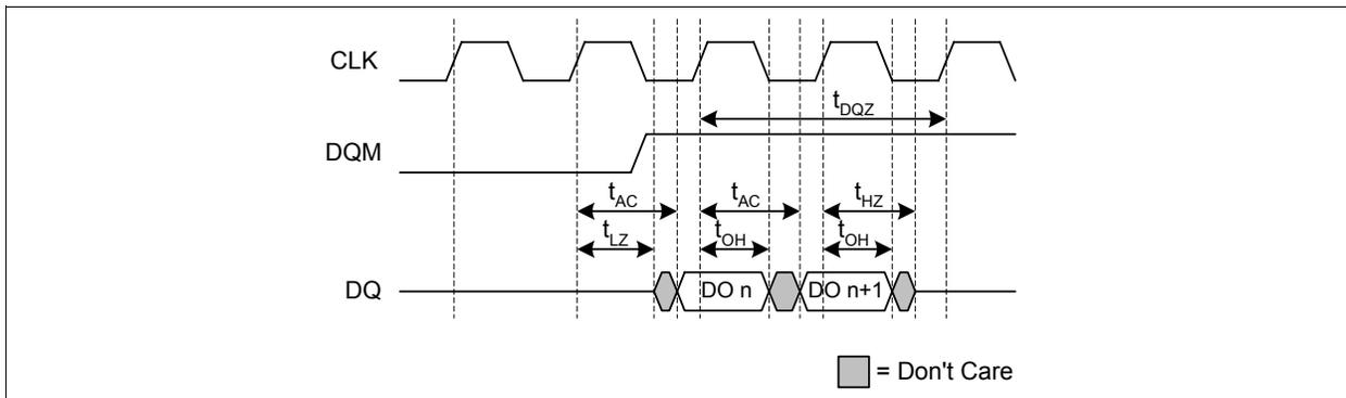
Figure 15 Basic READ Timing Parameters for DQs
