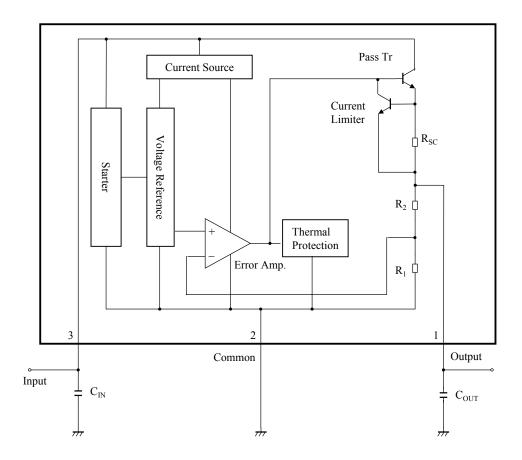
$$\begin{split} &C_{IN}: 0.33 \ \mu F \\ &C_{OUT}: 0.1 \ \mu F \\ &R_1: 4 \ k\Omega \\ &R_2: 3 \ k\Omega \end{split}$$
