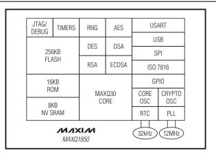
NOTE: THE BLOCK DIAGRAM SHOWS A TYPICAL SYSTEM CLOCK USED TO SUPPORT USB OPERATION AT 12MHz. MULTIPLE EXTERNAL CRYSTAL/CLOCK OPTIONS ARE AVAILABLE.
