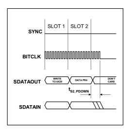
Figure 1 AC-Link Powerdown Timing
