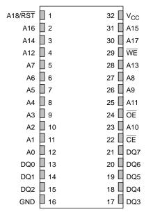
32-PIN ENCAPSULATED PACKAGE 740 MIL FLUSH
