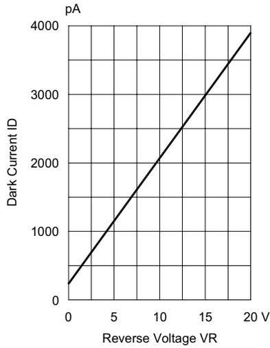
Fig.1 DARK CURRENT VS. REVERSE VOLTAGE
