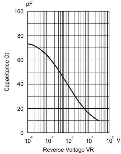
Fig.2 CAPACITANCE VS. REVERSE VOLTAGE
