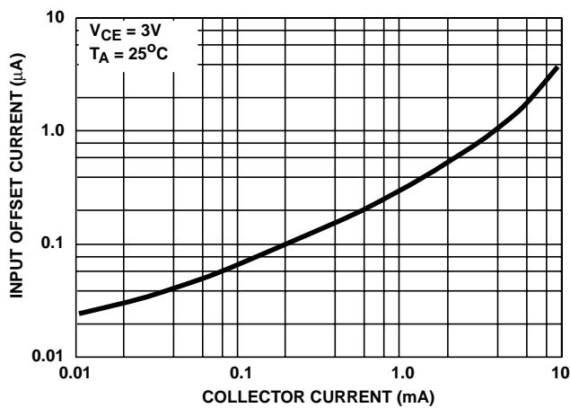
FIGURE 4. TYPICAL INPUT OFFSET CURRENT FOR
