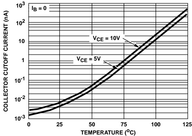
FIGURE 2. TYPICAL COLLECTOR-TO-EMITTER CUTOFF
