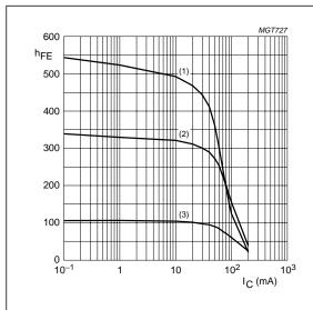
**BC847B**;  $V_{CE} = 5 \text{ V}$ .
