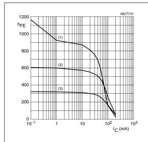
**BC847C**;  $V_{CE} = 5 \text{ V}$ .
