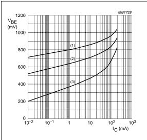
**BC847B**;  $V_{CE} = 5 \text{ V}$ .
