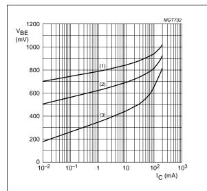
**BC847C**;  $V_{CE} = 5 \text{ V}$ .
