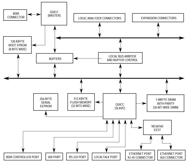
Figure B-3. QUADS Block Diagram
