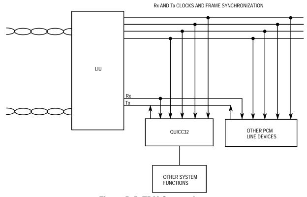
**Figure D-5. TDM Connections**
