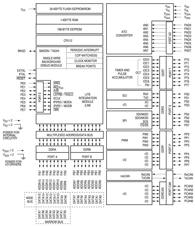
Figure 1-2. Block Diagram for MC68HC(9)12BC32
