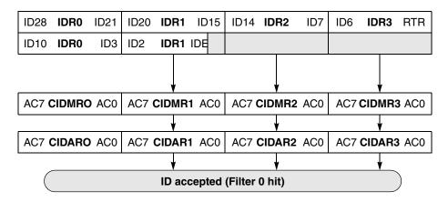
Figure 16-3. 32-Bit Maskable Identifier Acceptance Filter
