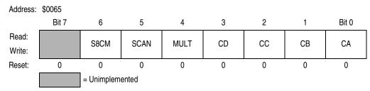
Figure 17-7. ATD Control Register 5 (ATDCTL5)
