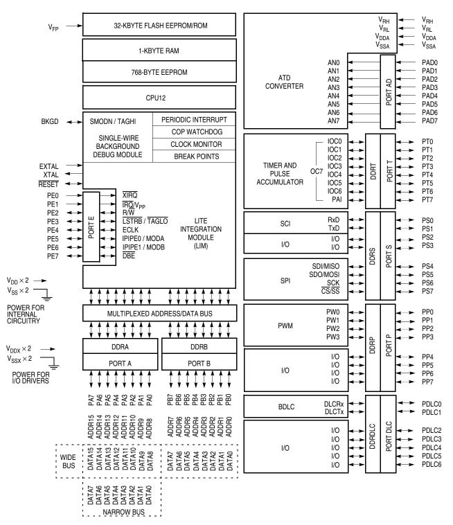
Figure 1-1. Block Diagram for MC68HC912B32 and MC68HC12BE32
