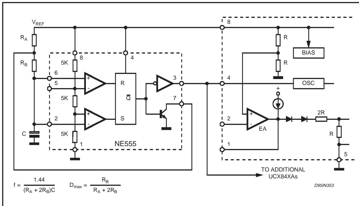
Figure 24: Soft-Start Circuit
