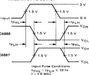
FIGURE 3 – WAVEFORMS FOR PROPAGATION DELAY TIMES – ENABLE TO OUTPUT
