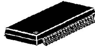
Outline 42P2R-A 0.8mm pitch 450mil ssop (8.4mm×17.5mm×2.0mm)
