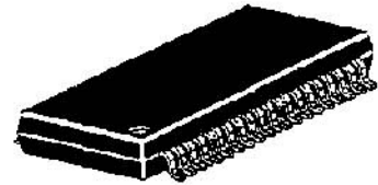
Outline 42P2R-A 0.8mm pitch 450mil ssop (8.4mm×17.5mm×2.0mm)
