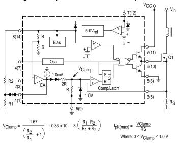
Figure 23. Soft-Start Circuit
