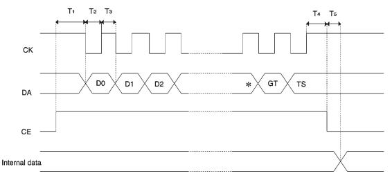
$T_1 \ge 15 \,\mu$ s  $T_2, T_3 > 1 \,\mu$ s  $T_4 > 0 \,\mu$ s  $T_5 < 15 \,\mu$ s
