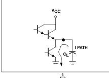
$(V_{OH} - V_{OL}) \sum_{i=1}^{s} C_{L_i} F_{OUT_i}$
