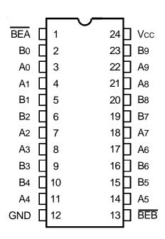
SOIC/ QSOP/ TSSOP TOP VIEW
