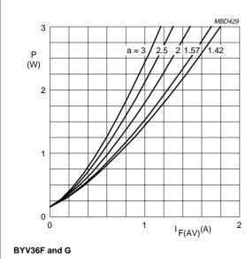
$a = I_{F(RMS)}/I_{F(AV)}; \ V_R = V_{RRMmax}; \ \delta = 0.5.$
