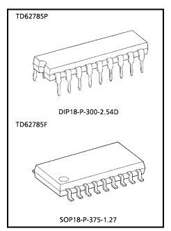
Weight DIP18-P-300-2.54D: 1.47 g (typ.) SOP18-P-375-1.27: 0.41 g (typ.)
