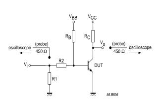
$$\begin{split} &V_i=0.5~V~to~4.2~V;~T=500~\mu s;~t_p=10~\mu s;~t_r=t_f\leq 1~ns.\\ &R1=56~\Omega;~R2=1~k\Omega;~R_B=1~k\Omega;~R_C=270~\Omega.\\ &V_{BB}=0.2~V;~V_{CC}=2.7~V. \end{split}$$
