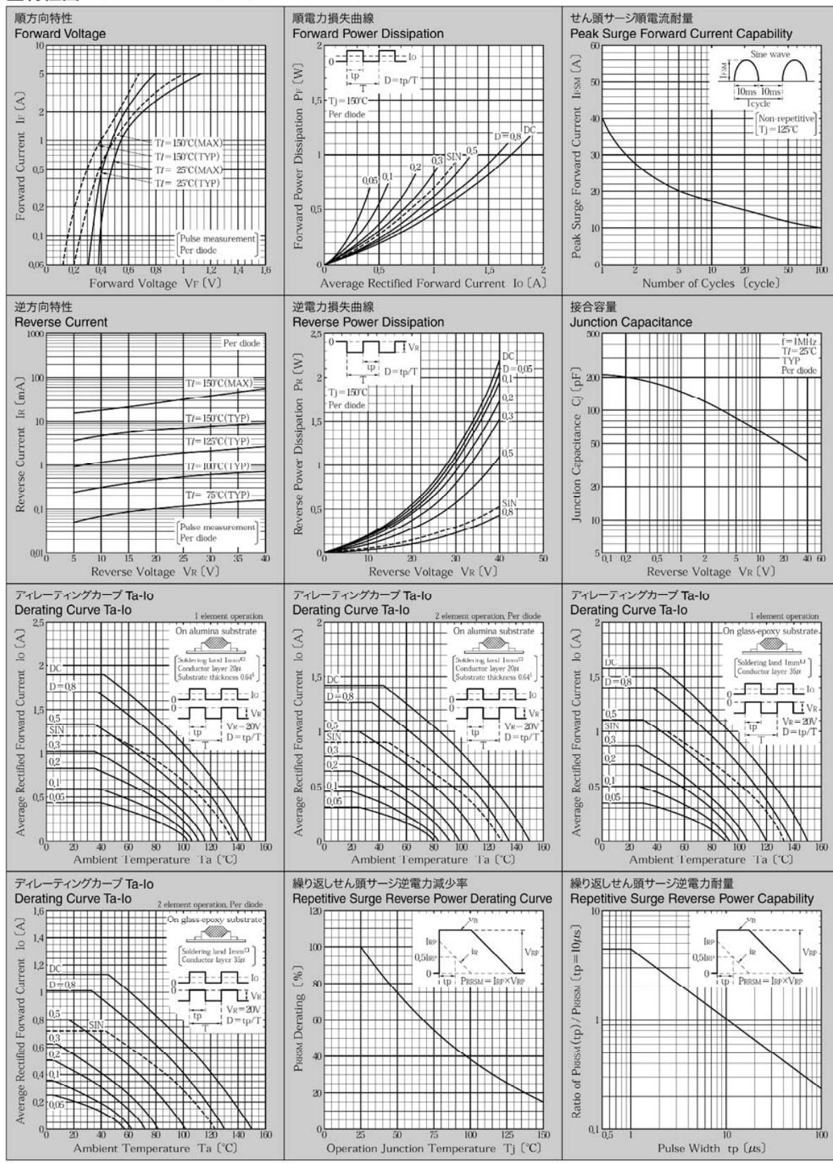
\* Sine wave は 50Hz で測定しています。 \* 50Hz sine wave is used for measurements.
