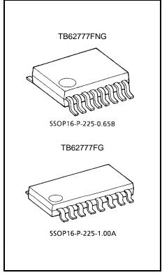
Weight: SSOP16-P-225-0.65B 0.07 g (typ.) SSOP16-P-225-1.00A 0.14 g (typ.)
