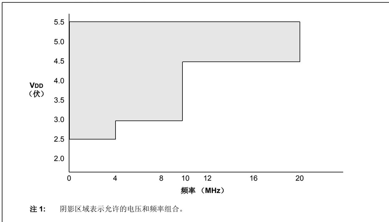
图 12-3: PIC16F676 (A/D 使能时) 的电压 - 频率曲线图
