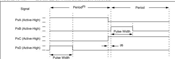
FIGURE 19-10: EXAMPLE OF PWM DIRECTION CHANGE
