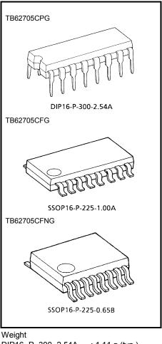
DIP16-P-300-2.54A : 1.11 g (typ.) SSOP16-P-225-1.00A : 0.14 g (typ.) SSOP16-P-225-0.65B : 0.07 g (typ.)
