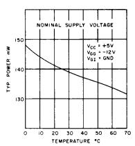
Fig.7 TYPICAL POWER CONSUMPTION (mW)
