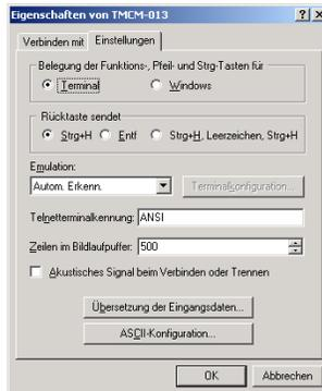
7. ASCII-Konfiguration im Einstellungs-Tab öffnen. OK klicken.
