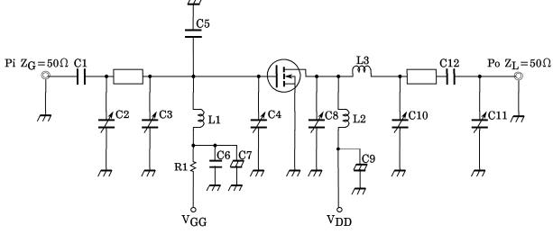
C7 :  $10\mu F$ , 50V ELECTROLYTIC CAPACITOR C8 :  $\sim 5pF$  VARIABLE CAPACITOR C9 :  $10\mu F$ , 250V ELECTROLYTIC CAPACITOR
