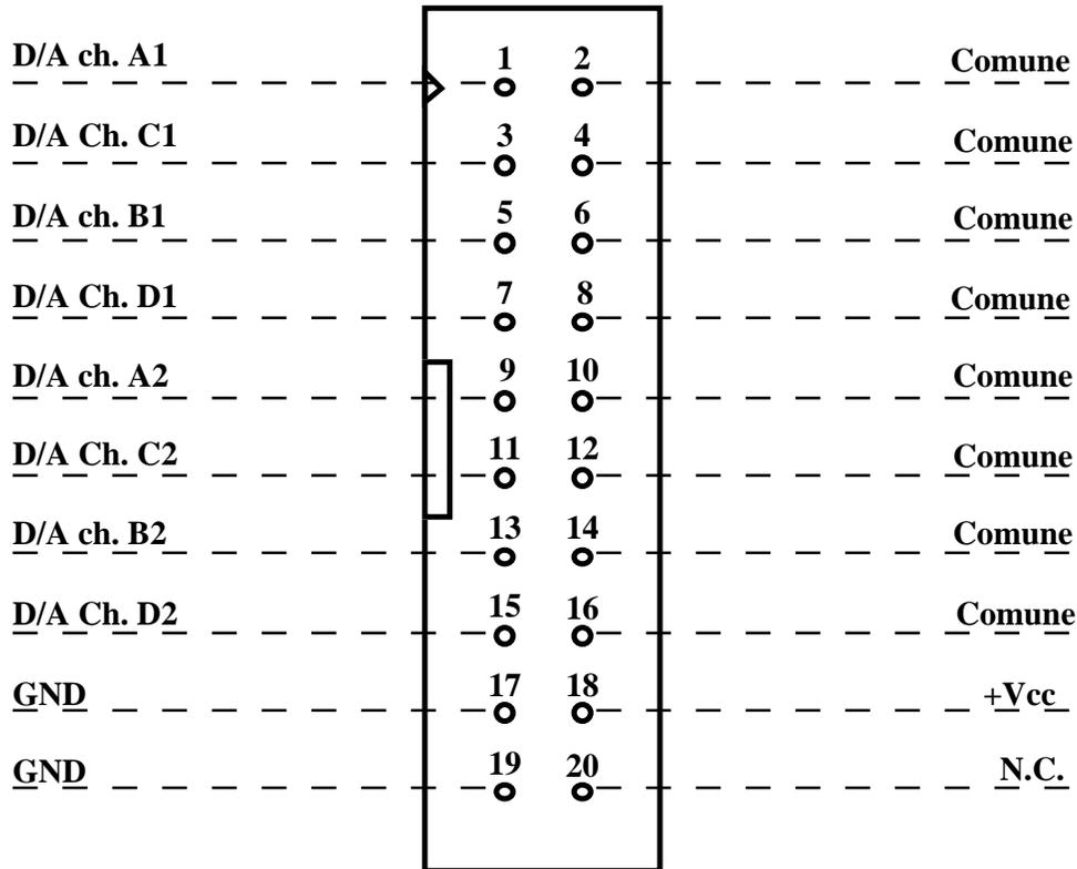
**CN2 - CONNETTORE PER USCITE D/A CONVERTER**
