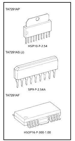
Weight HSIP10-P-2.54: 2.47 g (typ.) SIP9-P-2.54A: 0.92 g (typ.) HSOP16-P-300-1.00: 0.50 g (typ.)
