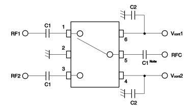
Note C1 : 0.5 to 2.0 GHz 56 pF : 2.0 to 6.0 GHz 8 pF C2 : 1 000 pF
