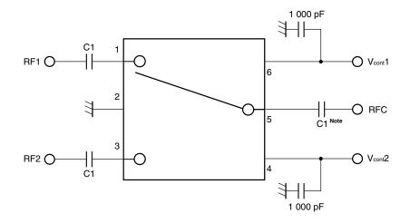
Note C1 : 0.05 to 0.5 GHz 1 000 pF : 0.5 to 2.0 GHz 56 pF : 2.0 to 6.0 GHz 8 pF
