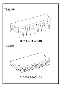
Weight DIP18-P-300-2.54D: 1.47 g (typ.) SSOP24-P-300-1.00: 0.32 g (typ.)
